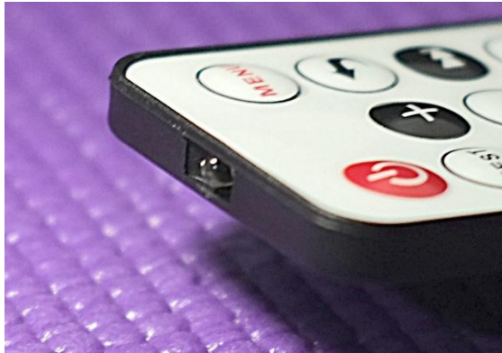
ภาพที่ 6-2-1 (ซ้าย) แอลอีดีภาคส่งที่ ET-IR REMOTE KEY (ขวา) ไอซี TSOP4838 ที่เป็นภาครับที่ติดตั้งอยู่กับ ET-iLED4x4 RGB
