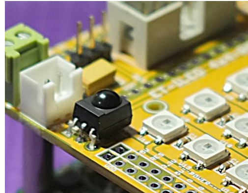
ภาพที่ 6-2-1 (ซ้าย) แอลอีดีภาคส่งที่ ET-IR REMOTE KEY (ขวา) ไอซี TSOP4838 ที่เป็นภาครับที่ติดตั้งอยู่กับ ET-iLED4x4 RGB
