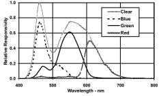
Figure 3. Sensor module color response.
