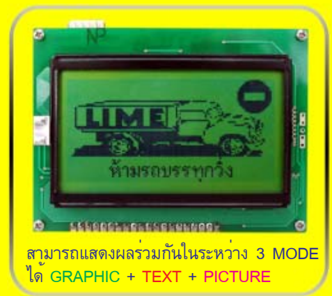
PICTURE MODE สามารถนำภาพจาก FILE แบบ BIT MAP ขนาด 128 X 64 มาแสดงผลได้
