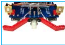
SW. SENSOR พร้อมชุดกันชนหน้า / SW. SENSOR หลัง / LED-RGB WS2812B จำนวน 6 ตัว / MINI SPEAKER / ลิ้งถ่าน
