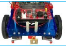
SW. SENSOR พร้อมชุดกันชนหน้า / SW. SENSOR หลัง / LED-RGB WS2812B จำนวน 6 ตัว / MINI SPEAKER / ลิ้งถ่าน
