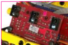
R-TRACKER 3 SENSOR ตรวจจับแสงเดินตามเส้น
