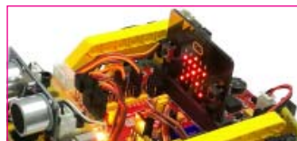
BBC MICRO:BIT พร้อมบอร์ดเสริม ET-BBC GPIO
