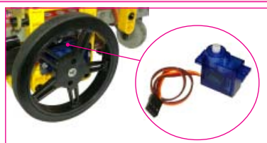
ใช้ SERVO MOTOR ในการขับเคลื่อน ROBOT
