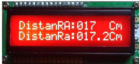
รูปที่ 6.1 แสดงค่าระยะการวัดบนจอ LCD โดยใช้คำสั่ง RA และ Ra ในการอ่านค่า
