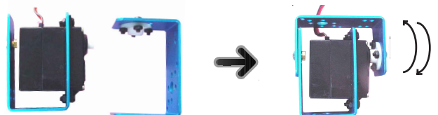
* ตัวอย่างการประกอบ R-JOINT เข้ากับ SERVO MOTOR
