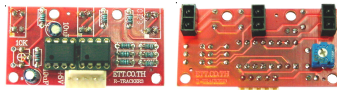
R-TRACKER 3 SENSOR ตรวจสอบแสงตามเส้นแบบ 3 ช่อง
