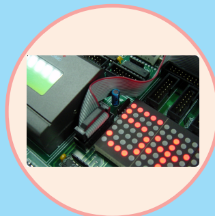
ใช้สายแพร เป็นสายต่อทดลอง พร้อม CONNECTOR แบบมีขา LOCK ป้องกันการตอสายผิด ...
