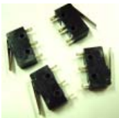
SW ตรวจสอบการชนใช้แบบ MICRO SW 4 ตัว พร้อม ตัวกันชน LEGO
