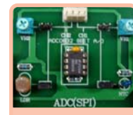
ชุดทดลอง A/D 8 BIT 2 CHANNELS
