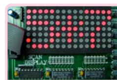
ชุดทดลอง DOT MATRIX LED ขนาด 15 X 7 DOT
