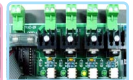
ชุดทดลอง SSR (SOLID STATE RELAY) ขนาด 4 CHANNELS
