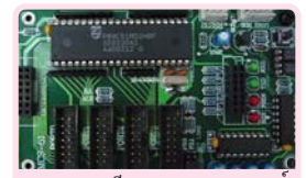
ET-LAB3A มี CPU MCS-51 เบอร์ P89C51RD2/V51RD2 หน่วยความ จำ 64K BYTE แบบ FLASH
