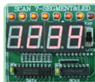
ชุดทดลอง LED 8 จุด & 7-SEGMENT 4 หลัก
