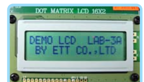
ชุดทดลอง LCD DISPLAY 16 CHARACTERS 2 LINES
