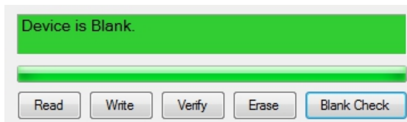
รูปที่ 2.44 หน้าจอรายงานผลว่าชิพพร้อมสำหรับถูกโปรแกรมของโปรแกรม PICKit 2
