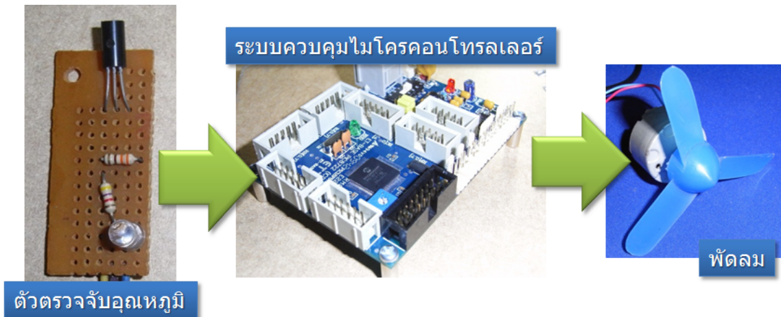
รูปที่ 1.3 ฝังระบบควบคุมการเปิด/ปิดพัดลมด้วยการตรวจจับอุณหภูมิ
