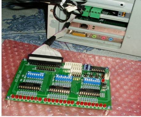
รูปที่ 2 การ์ด ET-PCI8255v3 ที่เชื่อมต่อกับ ET-Test I/O
