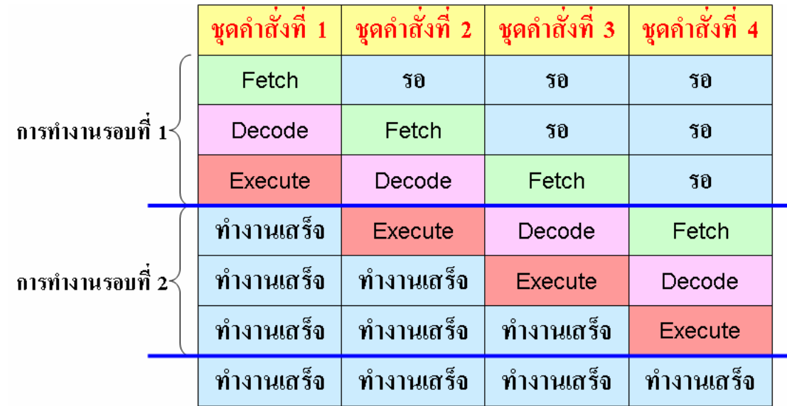
รูปที่ 1 ไปป์ไลน์ของ ARM7 ทั้ง 3 สเตจ
