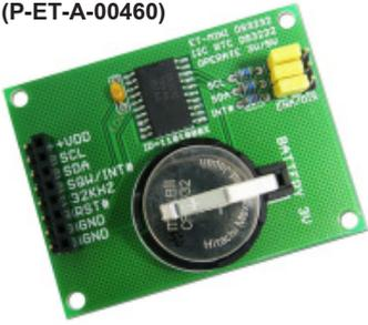
เป็นชุดต่อวงจรในแบบ I<sup>2</sup>C BUS เป็นวงจร RTC ที่มีส่วน CRYSTAL OSC อยู่ในตัว ทำให้มีความเที่ยงตรงในการทำงานของตัว RTC มากกว่าแบบอื่นๆ ใช้ RTC เบอร์ DS3232, ทำงาน 3V-5V, RAM ภายใน 236 BYTE, พร้อมวงจร BATTERY 3V ใช้ BACKUP ขั้ว INPUT สัญญาณเข้าแบบ 8 PIN ตัวผู้และตัวเมีย
