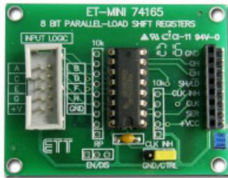
เป็นชุด SHIFT REGISTER PARALLEL-TO-SERIAL DATA CONVERSION ขนาด 8 บิต แบบ PARALLEL-IN, SERIAL-OUT ใช้สื่อสารแบบ SPI คือ รับข้อมูลเข้ามาในแบบขนาน และส่งข้อมูลออก OUTPUT ในแบบอนุกรมรองรับความถี่ CLOCK สูงสุด 35 MHz โดยบอร์ดนี้ใช้ IC เบอร์ 74LS165 ขา DATA IN แบบ 10 PIN BLOCK, ขา OUTPUT แบบ 8 PIN เป็นแบบ PIN HEADER ตัวผู้และตัวเมีย
