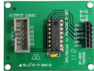
เป็นชุดต่อวงจร TTL ไอซีประเภท SERIAL TO PARALLEL ใช้เบอร์ 74HC595 จำนวน 1 ตัว ให้ OUTPUT ได้เป็นขนาด 8 BIT OUTPUT โดยมี INPUT เป็นแบบขั้ว 6 PIN ตัวผู้ และตัวเมีย ขั้ว OUTPUT เป็น 10 PIN BLOCK ETT พร้อมคู่มือการใช้งาน
