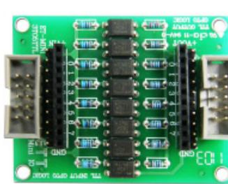
เป็นชุดวงจรต่อเปลี่ยนแปลงสัญญาณในระดับ 3V ให้เป็นสัญญาณในระดับ 5V จำนวน 8 ช่อง ใช้ต่อระหว่างวงจรหรือ CPU ที่มีระดับสัญญาณ 3V ซึ่งไม่สามารถต่อกับวงจรที่มีระดับสัญญาณ 5V ได้โดยตรง ใช้หลักการเปลี่ยนสัญญาณแบบ OPTO ISOLATION ใช้ PC817 จำนวน 8 ตัว ขั้ว INPUT และ OUTPUT เป็นขั้วแบบ 10PIN BLOCK ตัวผู้พร้อมคู่มือการใช้งาน
