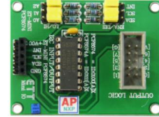
เป็นชุดต่อวงจรในแบบ I<sup>2</sup>C BUS เป็นวงจรประเภท PORT I/O ขนาด 8 BIT โดยเลือกใช้ IC เบอร์ PCF8574 พร้อม JUMPER เลือกตำแหน่งของตัว IC ในระบบ I<sup>2</sup>C ขั้ว INPUT สัญญาณเข้าแบบ 5 PIN ตัวผู้และตัวเมีย ขั้ว I/O เป็นแบบ 10 PIN BLOCK ETT พร้อมคู่มือการใช้งาน
