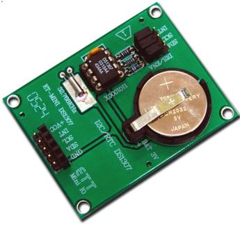
เป็นชุดต่อวงจรในแบบ I<sup>2</sup>C BUS โดยเป็นวงจร RTC ใช้เบอร์ DS1307 ขนาด 8 PIN พร้อมวงจร BATTERY 3V ใช้ BACKUP ข้อมูลของตัว RTC ขั้ว INPUT สัญญาณเข้าแบบ 5 PIN ตัวผู้และตัวเมีย พร้อมคู่มือการใช้งาน
