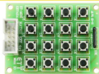
เป็นชุด KEY SWITCH ขนาด 4x4 (16ตัว) ต่อในแบบ MATRIX ใช้ TACT SW ขนาด 5x5 mm. ขั้วต่อของชุด KEY SW ออกเป็นแบบ 10 PIN ET BOX HEADER พร้อมคู่มือการใช้งาน
