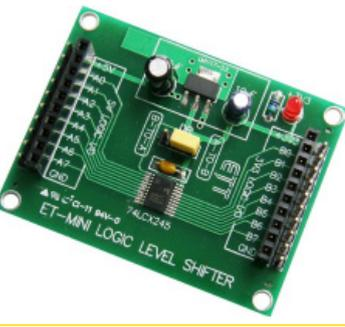
เป็นบอร์ดวงจรที่ใช้ในการเชื่อมต่อสัญญาณลอจิกระหว่างอุปกรณ์ 5V กับอุปกรณ์สัญญาณประเภท 3.3V (หรือ 3V) โดยใช้ไอซี 74LCX245 เป็นตัวกลางในการเชื่อมต่อ พร้อมวงจร REGULATOR 3.3V บนบอร์ด พร้อมคู่มือ
