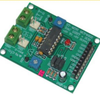
เป็นอีกหนึ่งในชุด ET-MINI BOARD เป็นวงจร D TO A ขนาด 12 BIT 2 ช่อง ใช้ไอซี เบอร์ MCP4922 ของ บริษัท MICROCHIP
