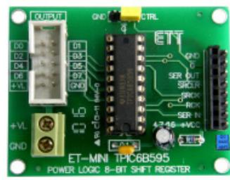
เป็นชุด POWER SHIFT REGISTER ขนาด 8 บิต แบบ SERIAL-IN เป็น PARALLEL-OUT ใช้สื่อสารแบบ SPI คือ รับข้อมูลเข้ามาในแบบอนุกรม และส่งข้อมูลออกทาง OUTPUT ในแบบขนาน โดย OUTPUT ในแต่ละบิต จะเป็นแบบ OPEN DRAIN สามารถรองรับกระแสไหลได้สูงสุด 500 mA แรงดันโหนดสูงสุด 50V ขั้วต่อ V-OUT เป็นแบบ TERMINAL 2 PIN, ขั้วต่อ OUTPUT เป็นแบบ 10 PIN BLOCK,
