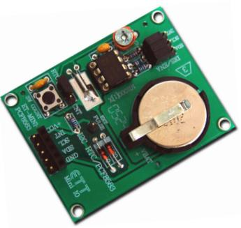
เป็นชุดต่อวงจรในแบบ I<sup>2</sup>C BUS โดยจะเป็นวงจรในแบบ RTC ใช้เบอร์ PCF8583 ของ บริษัท PHILIPS พร้อมวงจร BATTERY 3V ใช้ BACKUP ข้อมูลตัว RTC และ TACT SW ใช้นับความถี่ของสัญญาณอื่นๆ โดยทำ RTC นี้ให้เป็น COUNTER ขั้ว INPUT สัญญาณเข้าแบบ 5 PIN ตัวผู้และตัวเมียพร้อมคู่มือการใช้งาน
