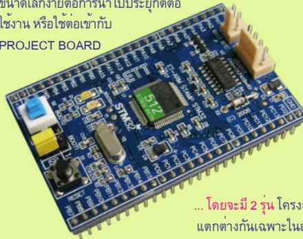
... โดยจะมี 2 รุ่น โครงสร้างและวงจรจะเหมือนกันทั้ง 2 รุ่น แตกต่างกันเฉพาะในส่วนของ CPU คือ
